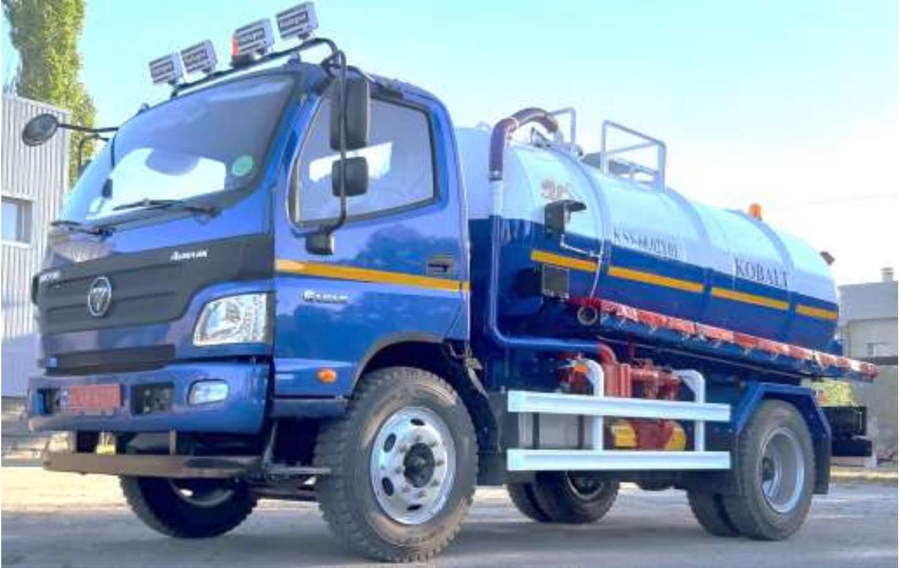
Машина вакуумная среднего класса с полезным объемом цистерны 13 м<sup>3</sup> на специальном полноприводном шасси FOTONDAIMLER, серии AUMARK CTX-L. Предназначен для механизированной очистки выгребных ям, колодцев, транспортировки и выгрузки жидких негорючих отходов.
