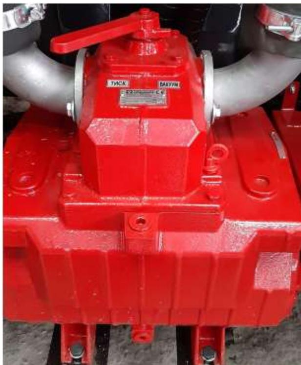
Вакуумные насосы с жидкостным охлаждением серии New Water представляют собой самый высокий Международный стандарт в технологии вакуумного всасывания. Корпус насоса из высокопрочного чугуна, гарантирует максимальную долговечность и отличный теплообмен. Производительность: 720 м<sup>3</sup> /час Мощность: 34 кВт Масса: 217 кг \*Специально рекомендованы Еврокомиссией для использования в коммунальном хозяйстве или промышленности.
