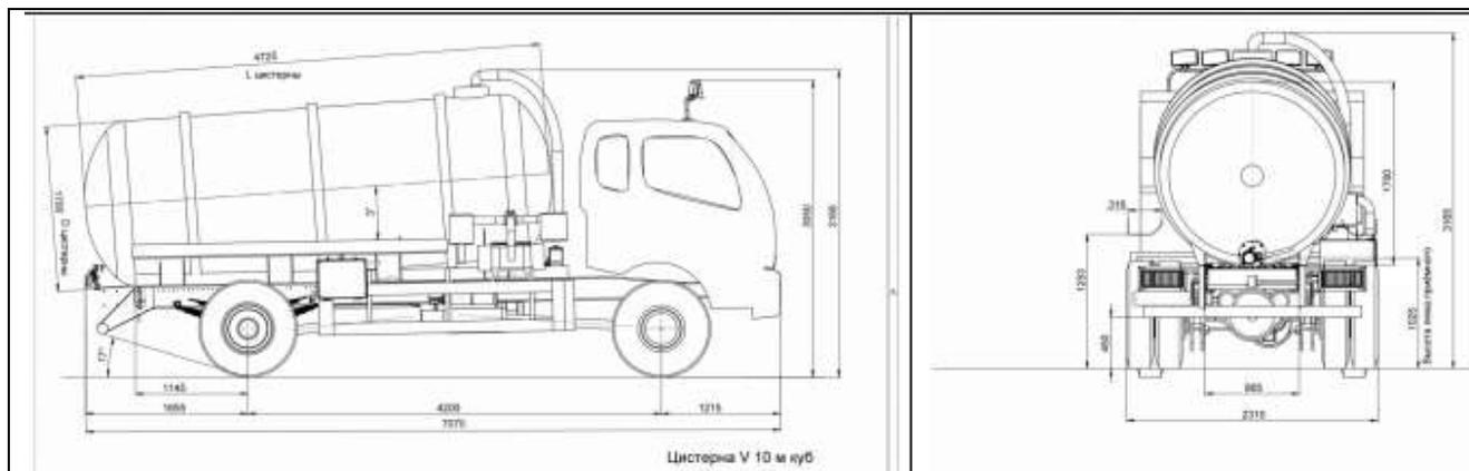
Выгрузка жидких отходов производится самотёком через затвор «Camlock» Ду 100мм, а также под давлением (в реверсном положении вакуумного насоса), для полной очистки цистерны.
