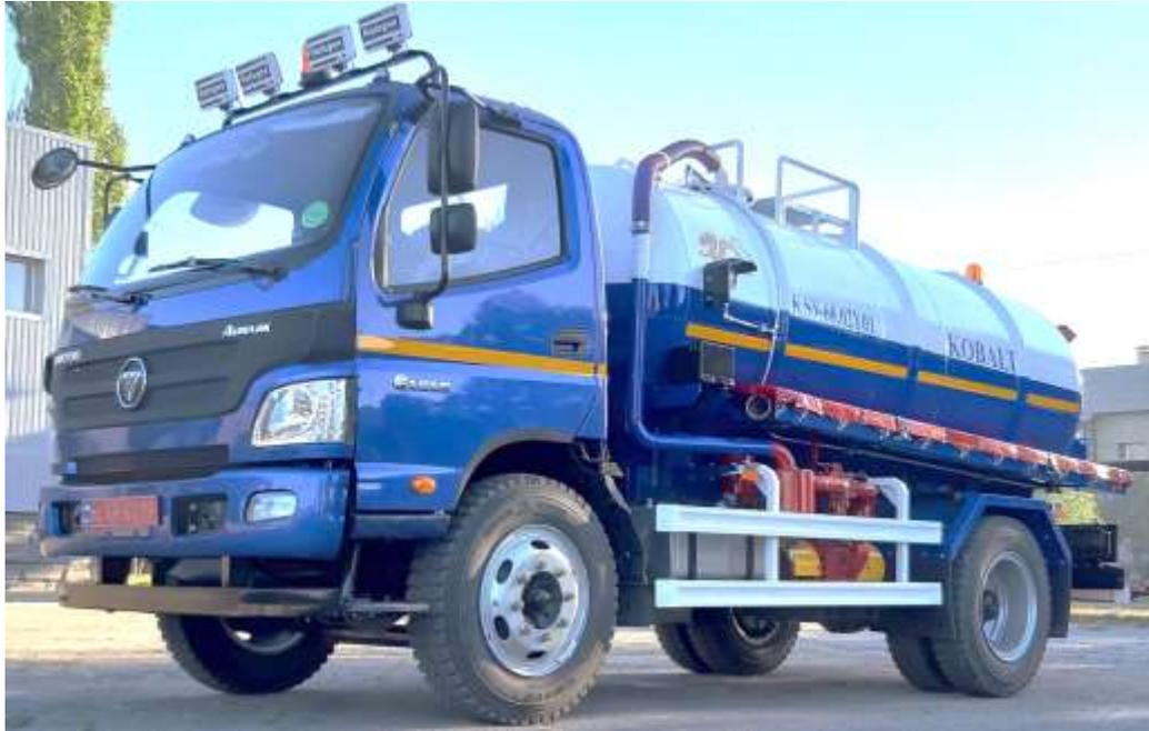
Машина Вакуумная-Ассенизатор среднего класса с полезным объемом цистерны 10.0 м3 на специальном полноприводном шасси FOTONDAIMLER, серии AUMARK СТХ-L. Предназначен для механизированной очистки выгребных ям, колодцев, транспортировки и выгрузки жидких негорючих отходов.
