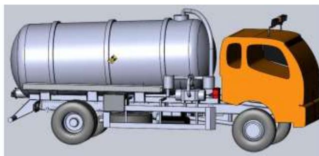
Цистерна крепится к раме шасси автомобиля под углом 30° при помощи специального надрамника и техпластины. Заднее глухое эллиптическое доньшко имеет затвор «Camlock» Ду 76 мм (Ду 100) и уровень заполнения цистерны.
