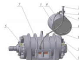
Схема змазки вакуумного насоса 1.Бак масляний;2.Корпус маслянки; 3.Гвинт регулювальний;4.Втулка оглядова; 5.Прес маслянки;6.Трійник;7.Штуцер; 8,9,10-Трубки
