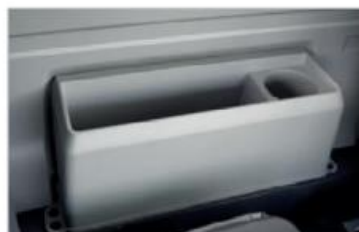
Речовий відсік на задній стінці кабіни Загальний об'єм- 4.9 літрів.
