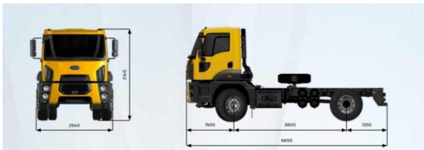
Креслення самоскида на шасі FORD 1833D DC
