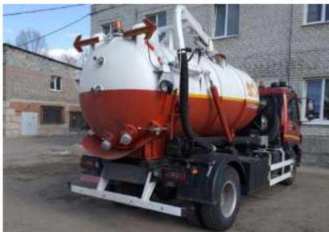
Модель КОВ-9 - это насосная спецтехника для откачки ила и нечистот, иными словами, илососная машина. Насосный автомобиль КОВ-9 оборудован на ходовой платформе Foton Daimler и предназначен для чистки колодцев вакуумным методом, выкачки ила из канализационной и ливнёвой системы и транспортировке откачанного содержимого к месту слива.
