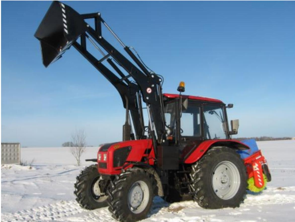
Погрузчик ДМЭ-1000 от компании «Киев-Спецтех» предназначен для выполнения погрузочно-разгрузочных работ, транспортирования сыпучих материалов на небольшие расстояния, механизированной очистки улиц, дорог, производственных территорий от песка, мусора и снега, засыпки траншей, ям насыпным грунтом, подъема и перемещения единичных и штучных грузов, планировки площадок, выполнения работ по подъему и перемещению единичных грузов в виде рулонов, тюков, связного солоमистого навоза.
