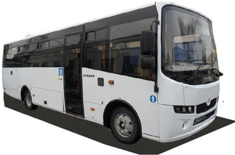
Автобус ISUZU Ataman A09216 от компании Киевспецтех это низкопольный пригородный автобус, построенный на базе производителя Isuzu. Предназначен для перевозки на пригородных маршрутах и обеспечивает оптимальное соотношение между экономичностью и стоимостью. Комплектация модели включает: передние выносные двери, задние двери - аварийные, клееные тонированные стекла, багажный отсек, автономный обогреватель.
