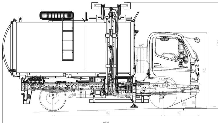
**МОДЕЛЬ: KGB-110SU «КОБАЛЬТ»**, Мусоровоз с боковой загрузкой с объёмом бункера 11.8 м<sup>3</sup> среднего класса, на шасси **FOTON DAIMLER**, серии **AUMARK CTX** предназначен для погрузки ТБО, прессования, транспортировки и выгрузки его на полигонах. Конструкция бункера надёжная и герметичная. Универсальный манипулятор-кантователь подходит для стандартных контейнеров объёмом - 0.75 м<sup>3</sup>, так и для евроконтейнеров объёмом -1.1 м<sup>3</sup>.
